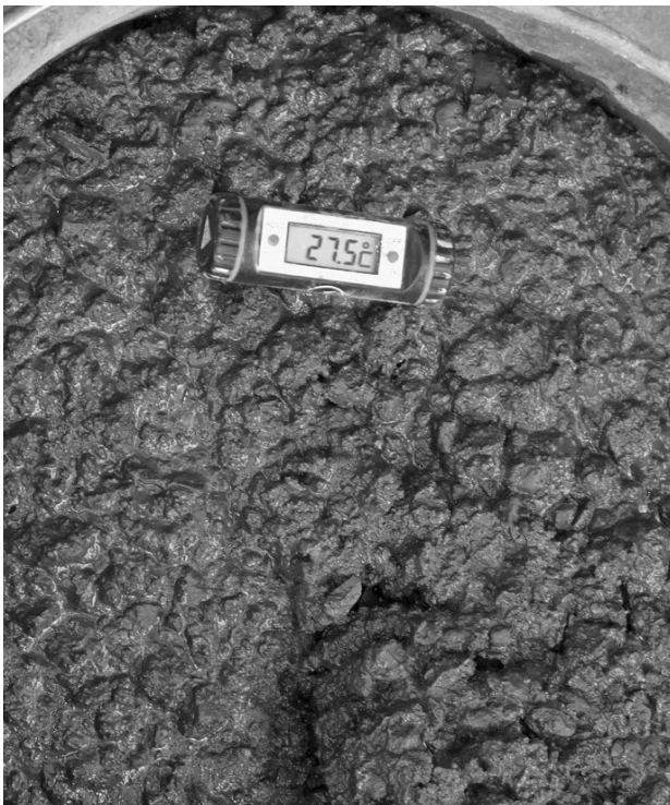
Bild 7: Vermehrte Kontrolle der Frischbetontemperatur auch nach Probekörperherstellung
